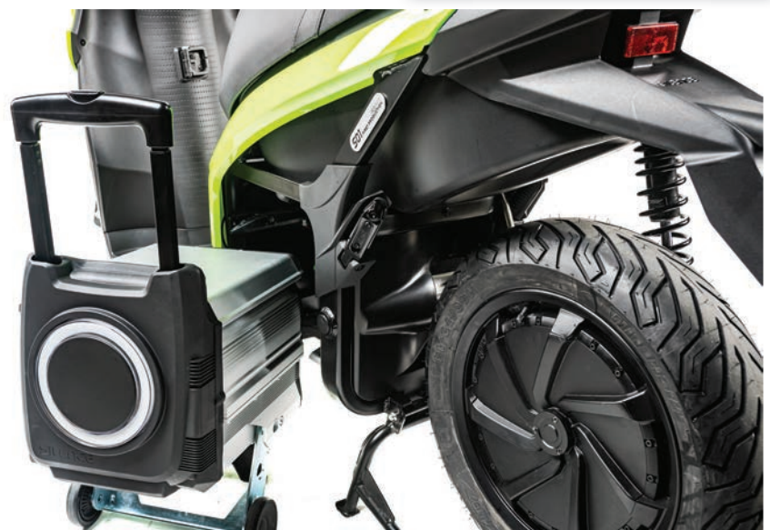
Литиево-йонната батерия е патентована количка с колелца, която се придвижва лесно и се зарежда във всеки 220V контакт
